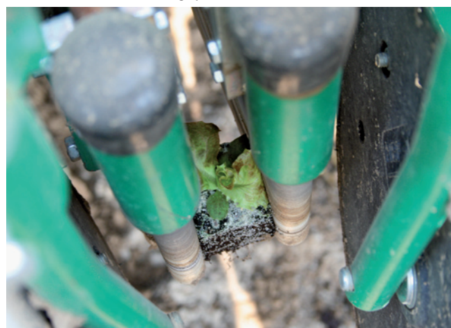
Zwischen den zwei vertikalen Bändern werden auch nasse Ballen nicht gequetscht
